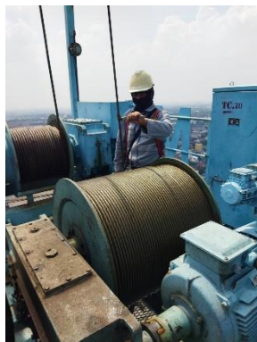
รูปที่ 36 ใช้จารบีเพื่อช่วยลดการเสียดสีของเครื่องจักร
